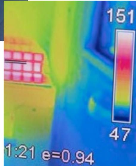
Avec un imageur thermique, la température extérieure des poêles de sauna peut être visualisée – un aspect important pour l'efficacité et la sûreté. Par exemple, le poêle VARIUS du Sauna SI est enduit de manière à minimiser le risque de blessure.
