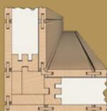
1 Le poteau d'angle avec connexion à rainure et languette assure une stabilité élevée de la construction des parois et du plafond.
