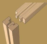
4 Les cadres ont un assemblage double rainure et languette pour une stabilité maximale.
